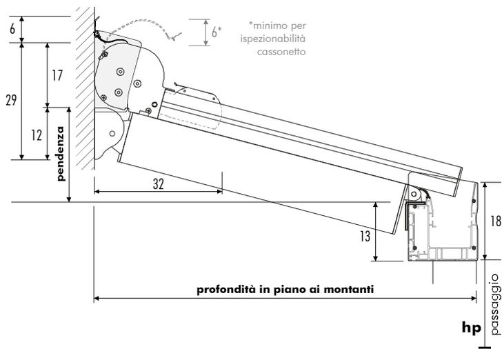
Pergola myShell® modulare, realizzata su misura, addossata a parete con arcarecci portanti, montanti a terra e **gronda frontale portante integrata**; dotata di sistema di copertura superiore mobile integrato con telo avvolgibile e dispositivo brevettato myShell® per il bloccaggio ed il tensionamento del telo a tenda completamente aperta. Struttura ad elevata resistenza al vento ed ai carichi accidentali, idonea anche per la schermatura solare e la protezione dalla pioggia.
