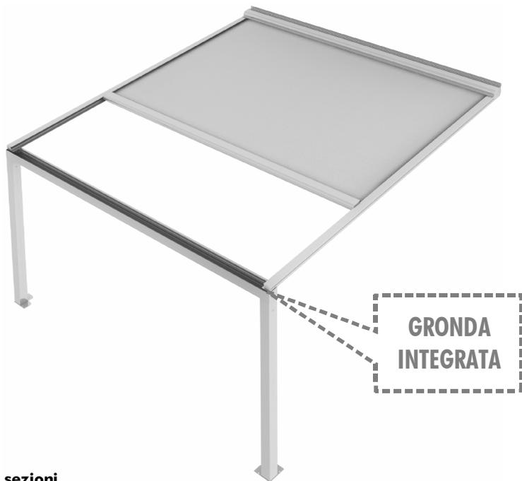
Pergola modulare myShell®, realizzata su misura, addossata a parete con montanti a terra e **gronda frontale portante integrata**; dotata di sistema di copertura superiore mobile integrato con telo avvolgibile e dispositivo brevettato myShell® per il bloccaggio ed il tensionamento del telo a tenda completamente aperta. Struttura ad elevata resistenza al vento idonea per la schermatura solare e la protezione dalla pioggia.
