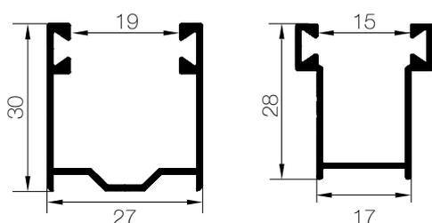
N.B. SECURLUX può essere montata su guide tradizionali, anche da sostituzione, utilizzando la guarnizione adeguata.
